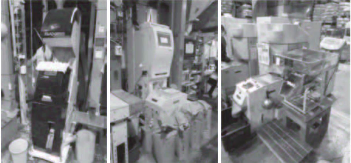
左から：玄米選別機、白米選別機、精米機。それぞれに石抜き機を搭載、お客様に渡すまで石抜き機を3度通し、石を100%抜けるよう配慮し、安全性向上に努める。
